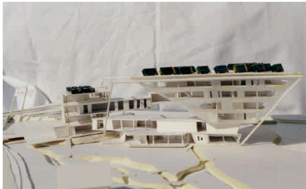
Oben: Westansicht - Modell ohne gläserne Hülle - Unten: Ostansicht mit Photovoltaikanlage auf dem Wohnzellenbaukörper, und einer Solarkollektoranlage auf dem Eingangsbaukörper
