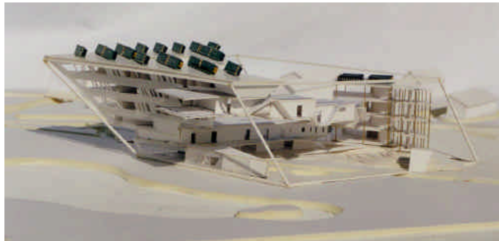
Oben: Westansicht - Modell ohne gläserne Hülle - Unten: Ostansicht mit Photovoltaikanlage auf dem Wohnzellenbaukörper, und einer Solarkollektoranlage auf dem Eingangsbaukörper
