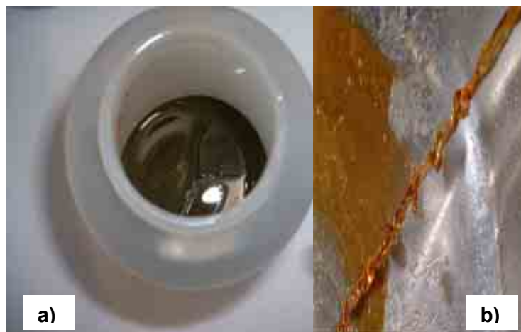
Abb. 48: Zentrifugiersuche des Jahres 2001 (TU-Graz): Foto a) Zentrifugenpellet im Zentrifugenbecher (Proteinkonzentrat); Foto b) Zentrifugenüberstand (Brown Juice)
