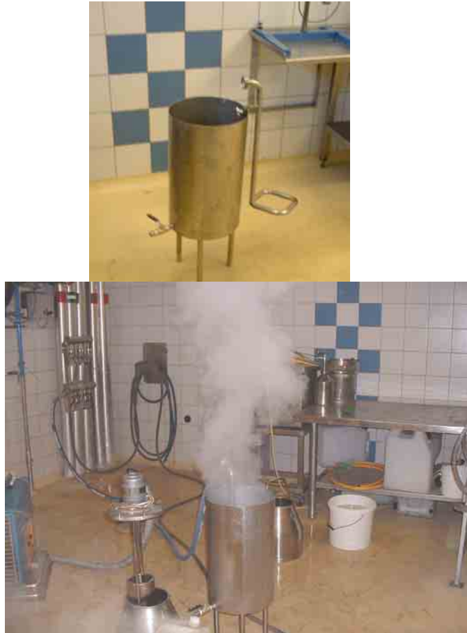
Abb. 47: Steaminjektion-Einheit – Sonderanfertigung bei der Fa. LACTOPROT AG in Hartberg
