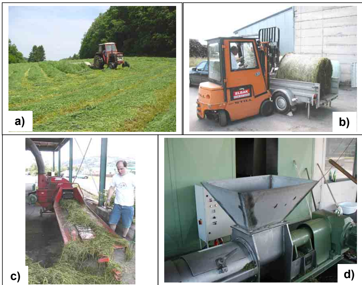
Abb. 7: a) Mähen der Klee graswiese, b) Anlieferung des frischen Klee grasballen, c) Zerkleinern des Klee gras, d) Versuchs presse – Pressversuche 2002 (Fotos: Kornberg Institut)
