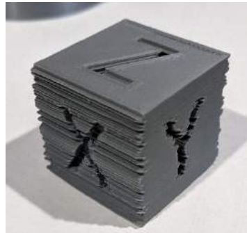
Abb.: 101 Layer Shifting
