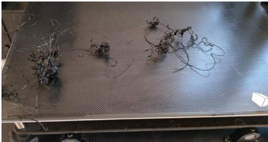
Abb.: 90 Keine Haftung am Druckbett
