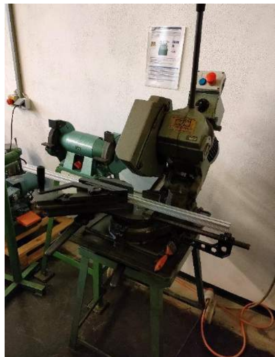
Abb.: 132 Zuschneiden eines Profils
