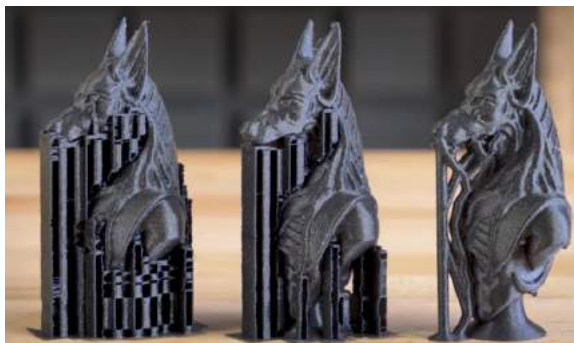
Abb.: 107 Beispiel für Supportstructure
