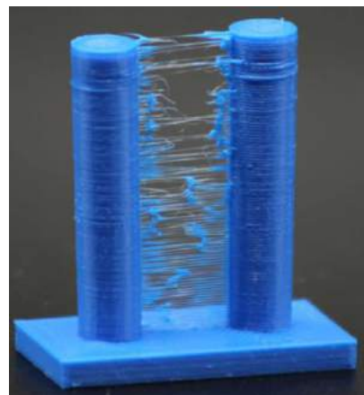
Abb.: 102 „Stringing“ am Bauteil
