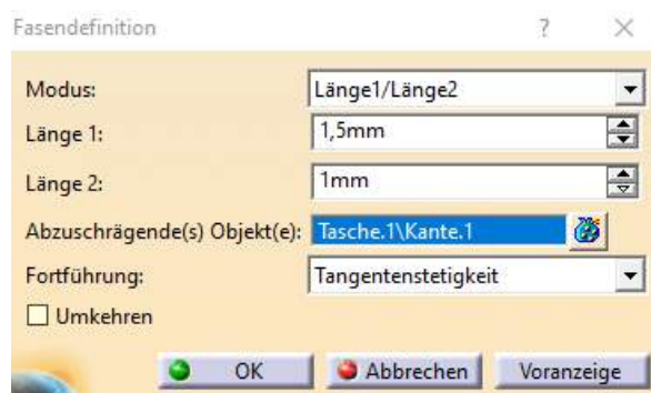
Abb.: 61 Fasendefinition Länge 1/Länge 2
