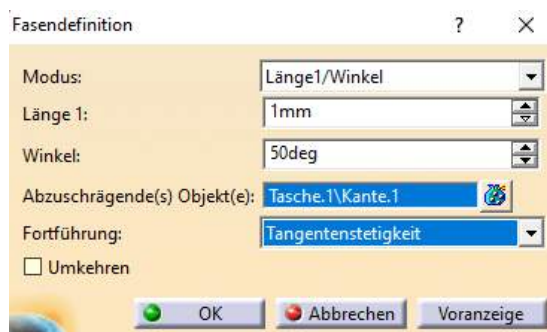
Abb.: 59 Fasendefinition Länge/Winkel
