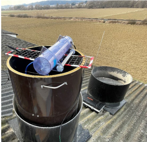
Abbildung 3. Aufsatz mit integriertem Messgerät zur Erfassung der Lufrate und mit Luftprobenahmegerät zur Entnahme von Geruchsproben.
